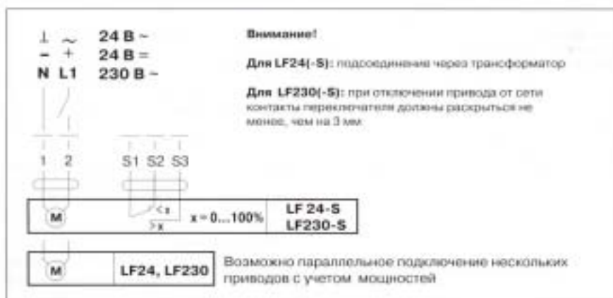
Схема электрических соединений
