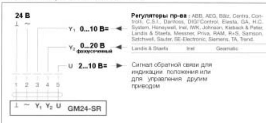
Схема электрических соединений
